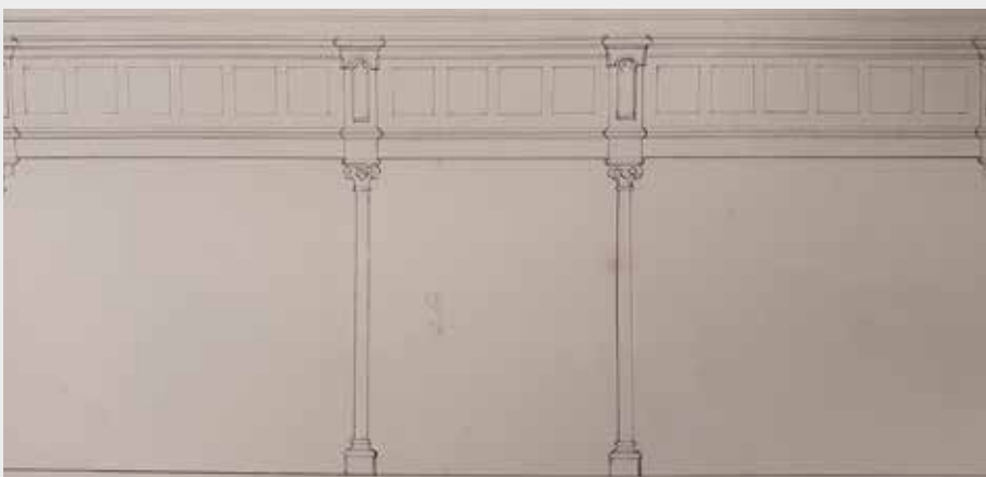
Afb. 15. (Ontwerp)tekening van de galerij uit de jaren 1860. Deze kent twee zuilen aan de voorzijde en een gesloten betimmerd front (HUA archief 1634 Vreeswijk Nederlandse Hervormde Kerk, inv. 136)
